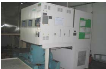
ตู้อบอุณหภูมิร้อน เย็น ขนาดเล็กและใหญ่ เพื่อใช้ทดสอบร่วมกับการสั่นสะเทือน
