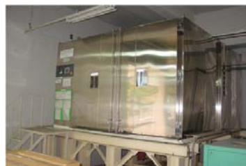
ตู้อบอุณหภูมิร้อน เย็น ขนาดเล็กและใหญ่ เพื่อใช้ทดสอบร่วมกับการสั่นสะเทือน
