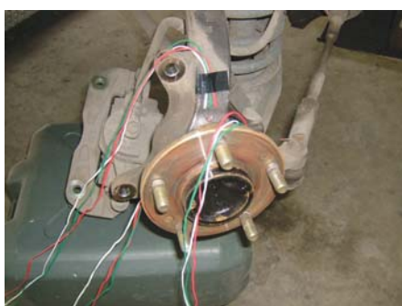
Strain gage ทั้งหมดถูกติดตั้งบน Knuckle ณ ตำแหน่งเดียวกันกับการทดสอบในห้องปฏิบัติการ
