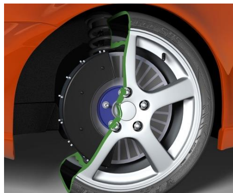
รูปที่ 3-12 โครงสร้างของมอเตอร์แบบ Axial Flux [9, 10]
