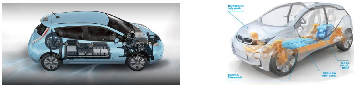
รูปที่ 3-16 รูปแบบการติดตั้งมอเตอร์และชุดขับเคลื่อนของ Nissan Leaf (ซ้าย) และ BMW i3 (ขวา) [12, 13]
