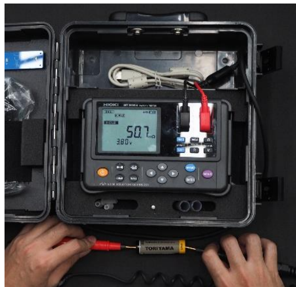
รูปที่ 3.9 การวัดความต้านทานภายในของแบตเตอรี่
