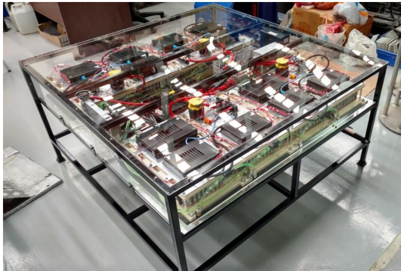
รูปที่ 2.33 แสดงภาพจริงของแพ็คเกจเตอรีต้นแบบโครงการวิจัยแบตเตอรี่ต้นแบบสำหรับรถยนต์นั่งที่ใช้พลังงานไฟฟ้า
