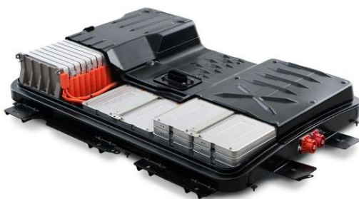
รูปที่ 2.25 แพ็กแบตเตอรี่ของ Nissan leaf ที่มีการใช้การพาความร้อน(Natural Air Convection) [11]
