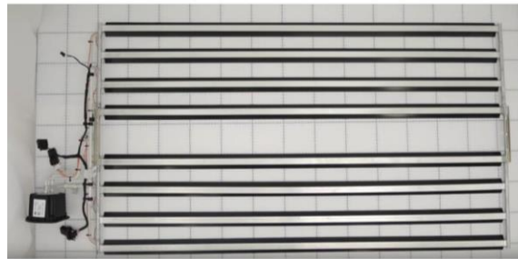
รูปที่ 2.31 แสดงโครงสร้างท่อระบายความร้อนที่ของ BMW [15]
