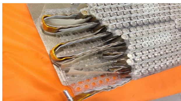
รูปที่ 2.28 แสดงทิศทางการวางท่อระบายความร้อนภายในโมดูลแบตเตอรี่ ของ Tesla Model S [12, 13]
