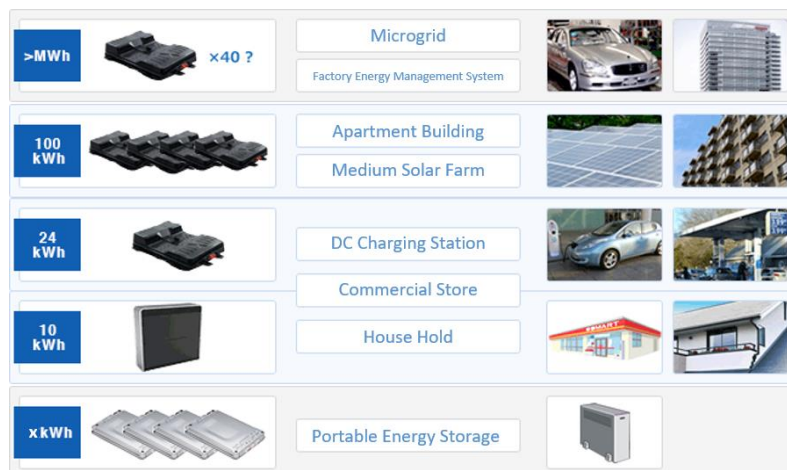
ภาพที่ 3-9 รูปแบบการ Reuse และรีแพบริเคท แบตเตอรี่ลิเทียมไอออนของรถยนต์ Nissan Leaf เพื่อให้มีความจุตามการนำไปใช้งาน
